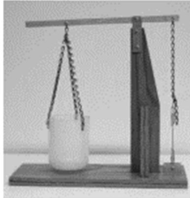
Il problema durante lo svolgimento del test è la rottura nelle zone di aggancio dello spaghetti ai morsetti dell'apparecchiatura utilizzata. Per ovviare al problema si potrebbero fissare delle coppiglie agli estremi dello spaghetti mediante colla epossidica, facendo in modo che lo spaghetti e la colla non si estendano fin dentro la testa delle coppiglie. Il campione dovrà pertanto essere preparato prima dello svolgimento della prova in modo che la colla raggiunga la sua massima tenuta.
