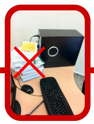
È vietato poggiare materiale cartaceo o di altro tipo sui sistemi di aerazione delle apparecchiature elettroniche.
